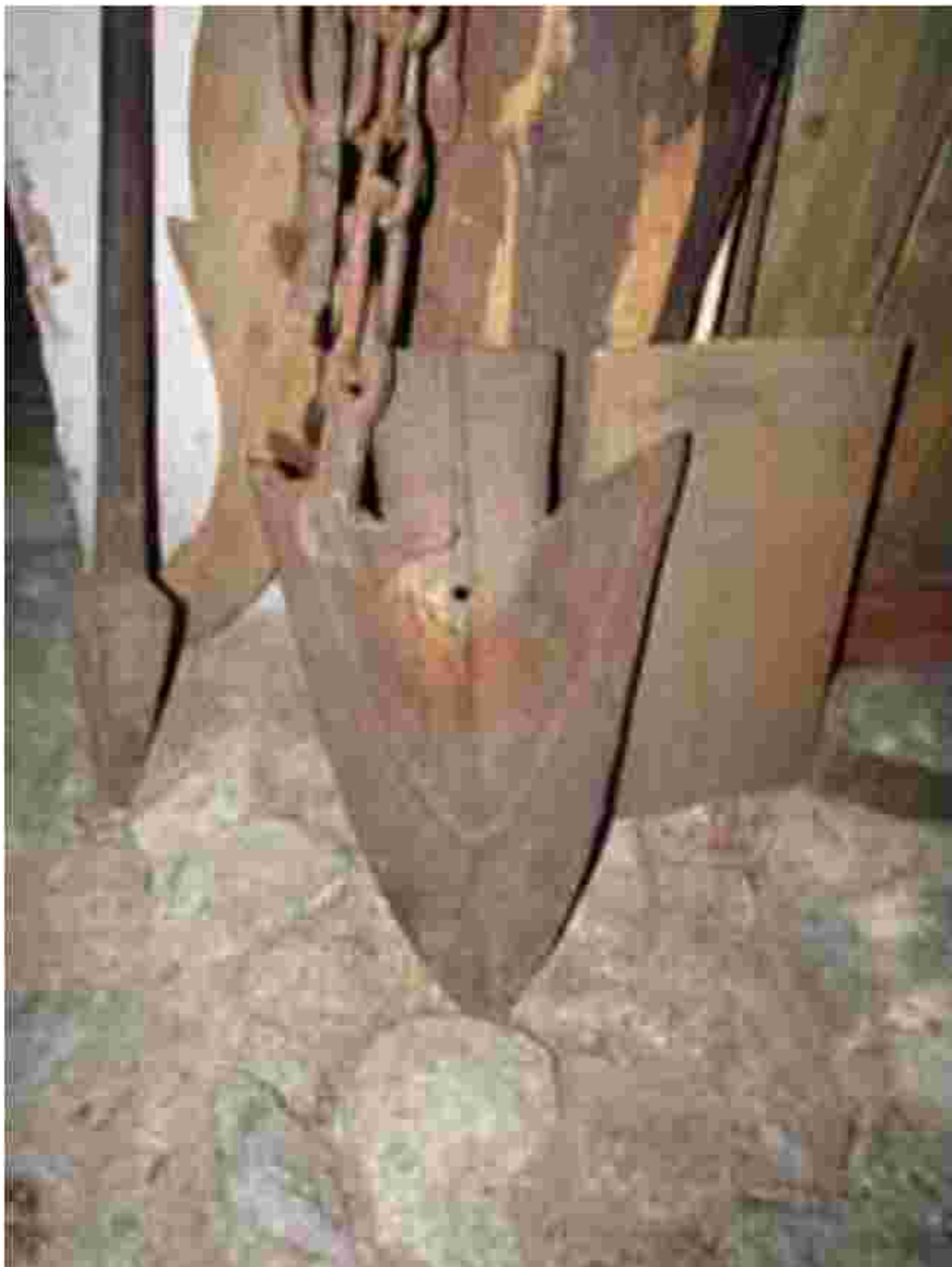
Pflugschar mit erneuerter Schnittkante. Dölsach, Fotoarchiv Brunnenburg
